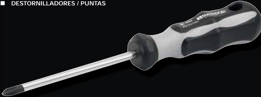
Con punta bruñida para un ajuste preciso y permanente en el tornillo. Zona de movimiento dura y negra de plástico especial para un agarre rápido con baja fricción. Zona de agarre gris, blanda y antideslizante, de plástico TPE para una sujeción segura con la máxima presión. Fácil de identificar gracias al marcado claro del perfil en la cabeza.
